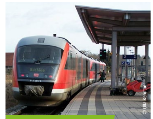
Der VT644 hat wie der VT650 einen stufenlosen Einstieg.
